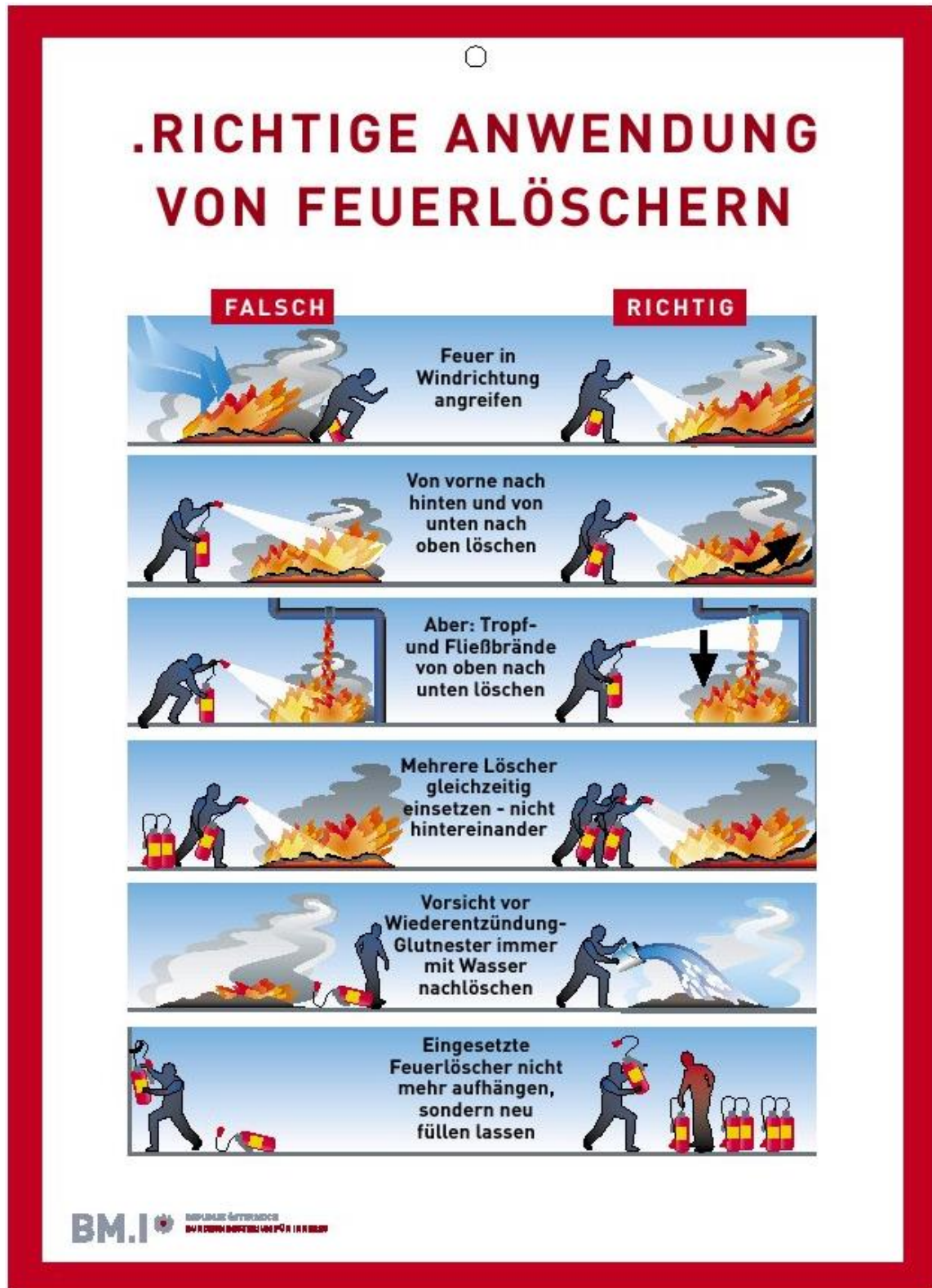
Abb. 5.1: Benützung eines Handfeuerlöschers (Quelle: TRVB O 119 06, S. 15)
