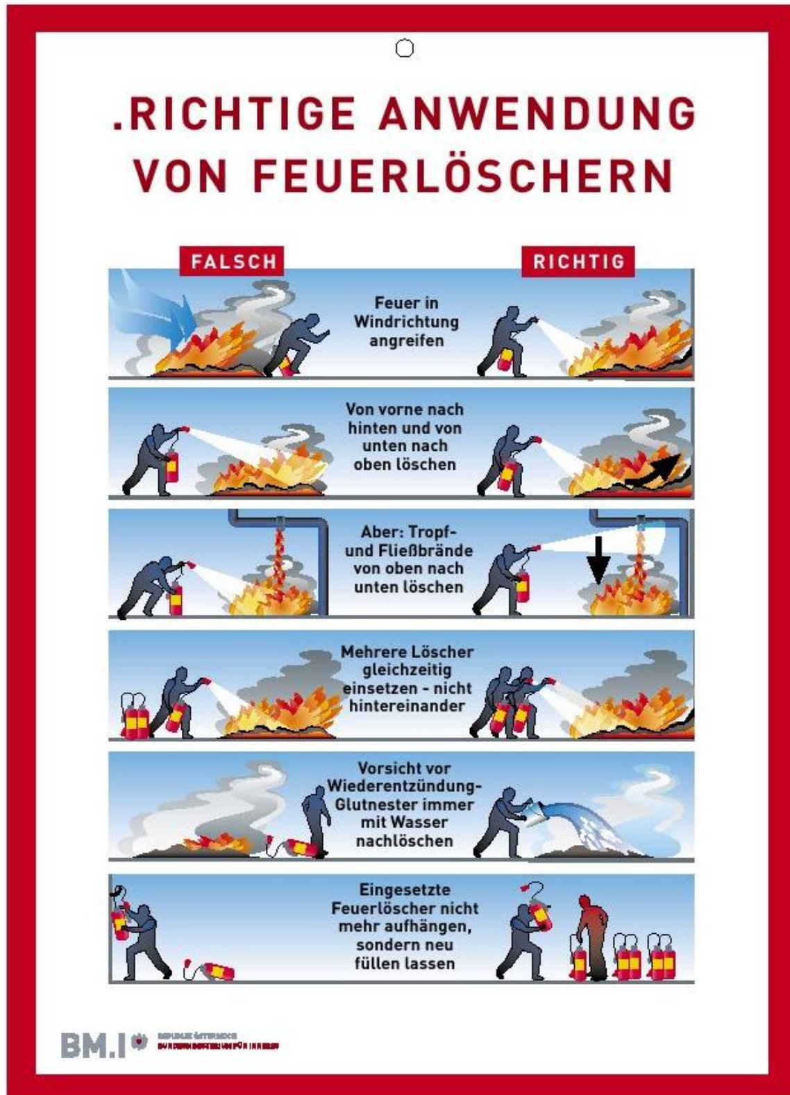
Abb. 5.1: Benützung eines Handfeuerlöschers (Quelle: TRVB O 119 06, S. 15)
